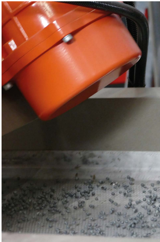
LDPE-Granulierung in der Palurec-Anlage
